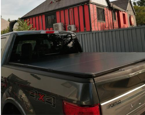
Tapas rígida de tres pliegues de GA2 para pick up de camionetas.
